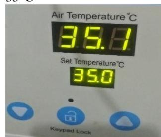
Gambar 19. tampilan suhu di inkubator bayi dengan pengaturan 35°C
